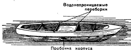
Рис. 2. Корпус модели с водонепроницаемыми переборками.
