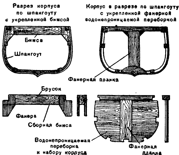
Рис. 17. Конструкция бимсы и водонепроницаемой переборки.
