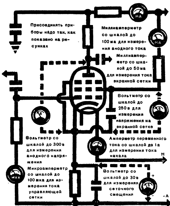
Рис. 20. Измерение режима ламп в радиоконструкциях.
