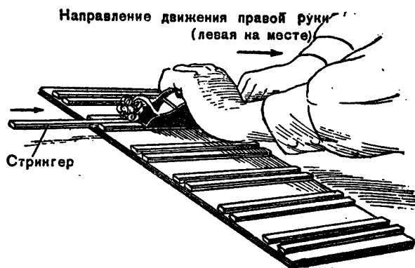
Рис. 11. Способ изготовления стрингеров.
