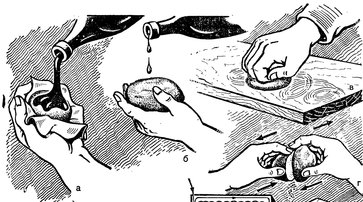
Рис. 42. Полирование поверхности изделий из древесины:
